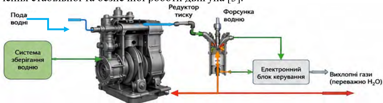
Рис. 2 - Принципова схема використання водню в двигуні внутрішнього згоряння
