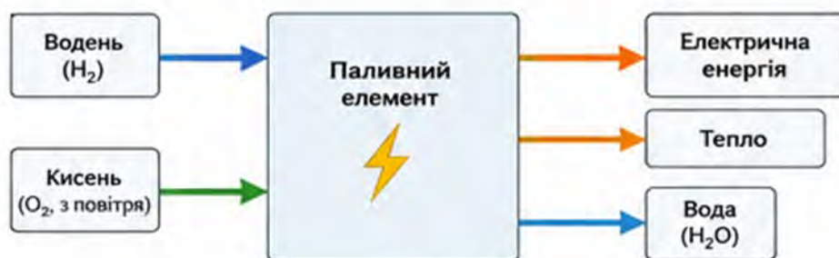
Рис. 3 – Принципова схема воднево-паливного елемента та
