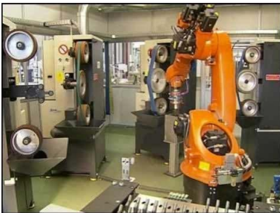
Рис. 1 — Роботизована система полірування після 3D-друку (KUKA LBR iiwa).
