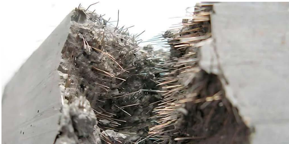
Рис. 2 – Зовнішній вигляд сталевібробетону / структура сталевібробетону зі сталеною фіброю
